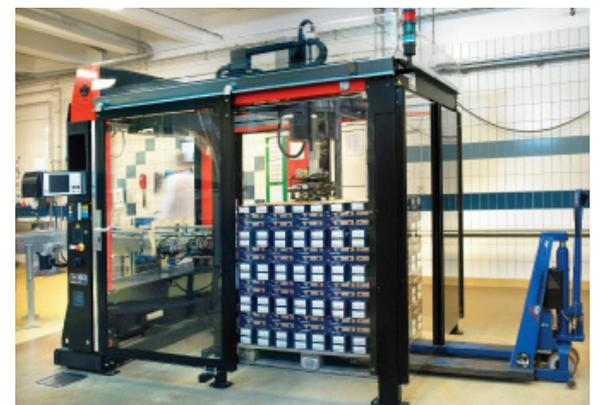
Der kompakte SOCO SYSTEM Palettierroboter bei Arla Foods in Gjesing/Dänemark nimmt nur ein wenig mehr Platz als eine Palette auf. Erstklassige Benutzerfreundlichkeit mit Touchscreen und Software ermöglicht Berechnung neuer und optimierter Palettenmuster oder Wechsel in existierende Palettenmuster. Foto: SOCO SYSTEM
